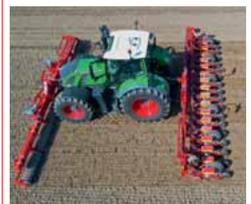
Die Güttler Mediana 820 ist für hohe Leistungen bei der Rübensaat entwickelt worden. Im Frontanbau passt sie optimal zu 18-reihigen Einzelkornsäegeräten im Heck des Traktors und schafft ein perfektes Saatbett auch unter schwierigen Bedingungen: Im Saathorizont fein, fest und feucht mit einem grob-krümeligen Oberboden, der vor Verschlammung und Erosion schützt. Ackern und Säen in einer Überfahrt.
